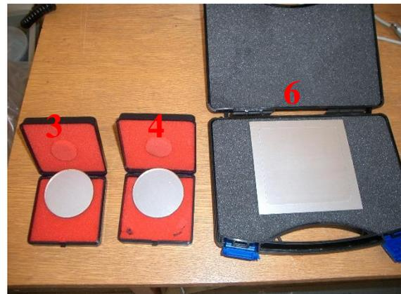
**Abb. 10** Das Bild zeigt auf der linken Seite die Kalibrierquelle **Nr. 1** **PD951**, in der Mitte **Nr. 2** **BU164** ( $^{14}C$ , R = 1,4 cm) auf der rechten Seite **Nr. 5** **BH218** ( $^{238}Pu$ , R = 10 cm).
