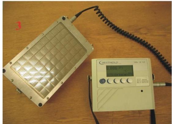
**Abb. 5** Das Bild zeigt die Tritiumsonde **Nr. 4 LB1239** zusammen mit dem UMO. Erkennbar ist die fensterlose Öffnung der Tritiumsonde, die nur mit einem sehr dünnen Gitter versehen ist. (Behandeln Sie deshalb die Sonde mit besonderer Vorsicht.)
