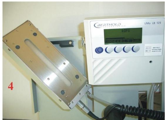
**Abb. 6** Im Bild erkennt man wieder den UMO, diesmal in Kombination mit der Proportional-Endfenstersonde **5 LB1238**. Die Sonde ist besonders geeignet für die Untersuchung von Hohlräumen und Rohrleitungen.
