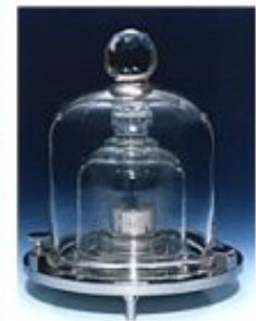
Das nationale Kilogramm-Prototyp der Bundesrepublik Deutschland in der PTB ( www.ptb.de ). Es besteht aus einer Platin-Iridium-Legierung und wird etwa alle zehn Jahre mit dem internationalen Kilogramm-Prototyp in Sèvres bei Paris verglichen.
