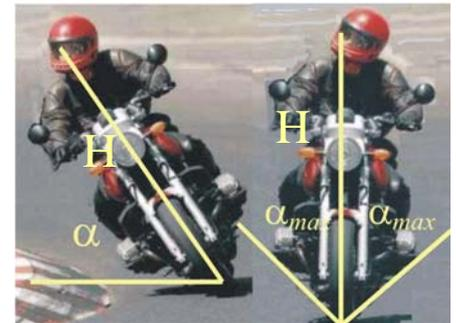
a. Betrachten Sie eine Motorradfahrt mit gleichförmiger Bahngeschwindigkeit  $v_B = 36 \text{ km/h}$  auf einer Kreisstrecke mit dem Radius  $R = 40 \text{ m}$ . Welche Schräglage hat das Motorrad?
