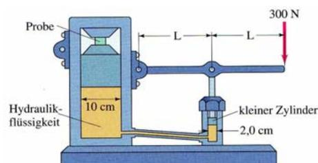
2. Kraft auf die Probe  $F_g = 15000 \text{ N}$ ; Druck auf die Probe  $p = 3,75 \cdot 10^7 \text{ Pa}$
