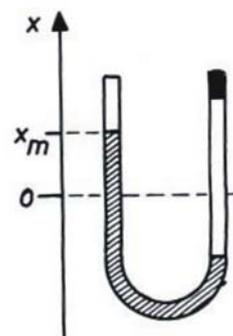
Zum Zeitpunkt  $t = 0$  wird der Verschluss des U-Rohres geöffnet und die Flüssigkeitssäule beginnt zu schwingen.
